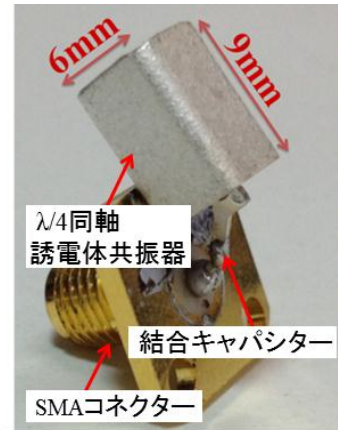
図3 \lambda/4 同軸誘電体共振器
