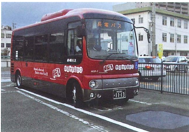
図 18 WEB-3 と 1 次側コイルの設置状況
