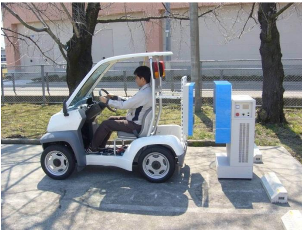
図 1 1kW ワイヤレス電力伝送デモシステム
