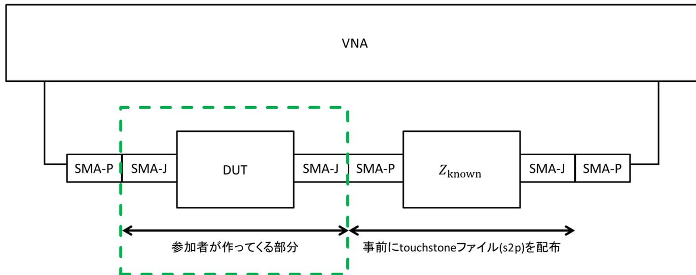
**概要:**自作の2ポート受動回路を、運営側が準備した基板を介してネットワークアナライザで測定より整合が取れた回路が勝者！得意な周波数帯の部門を選んでチャレンジできます！
