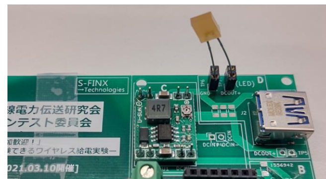
※極性に注意してLEDを受電基板に接続する。 ※図のLEDと配布したLEDは異なります。
