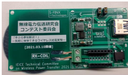
B, コネクタにコイル両端をそれぞれ差し込み、ドライバーで締める。極性はありません。
