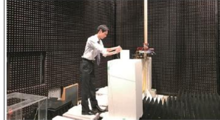
図6 電波暗室におけるレクテナ測定の様子
