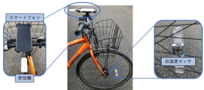
図2. データ計測装置を設置した自転車の外観
