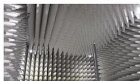
電波暗室の電波吸収体(三角錐形)
