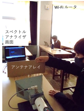
アンテナアレイの基礎実験 (左) l=122mmアレイ、(右) l=61mmアレイ 透過減衰率差 約2dB
