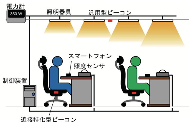
図 1. 座席ビーコン型知的照明システムの構成
