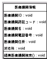
図 19 提携医療機関連携をクラス図へ変換した図 (CASE ツール)
