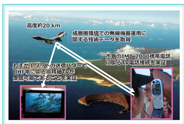
図6 Pathfinder Plus を用いた通信ミッション (文献(18), (19)を基に作成)
