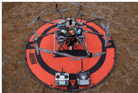
図 16 IMU を搭載した精密飛行ドローン「サルタヒコ」
