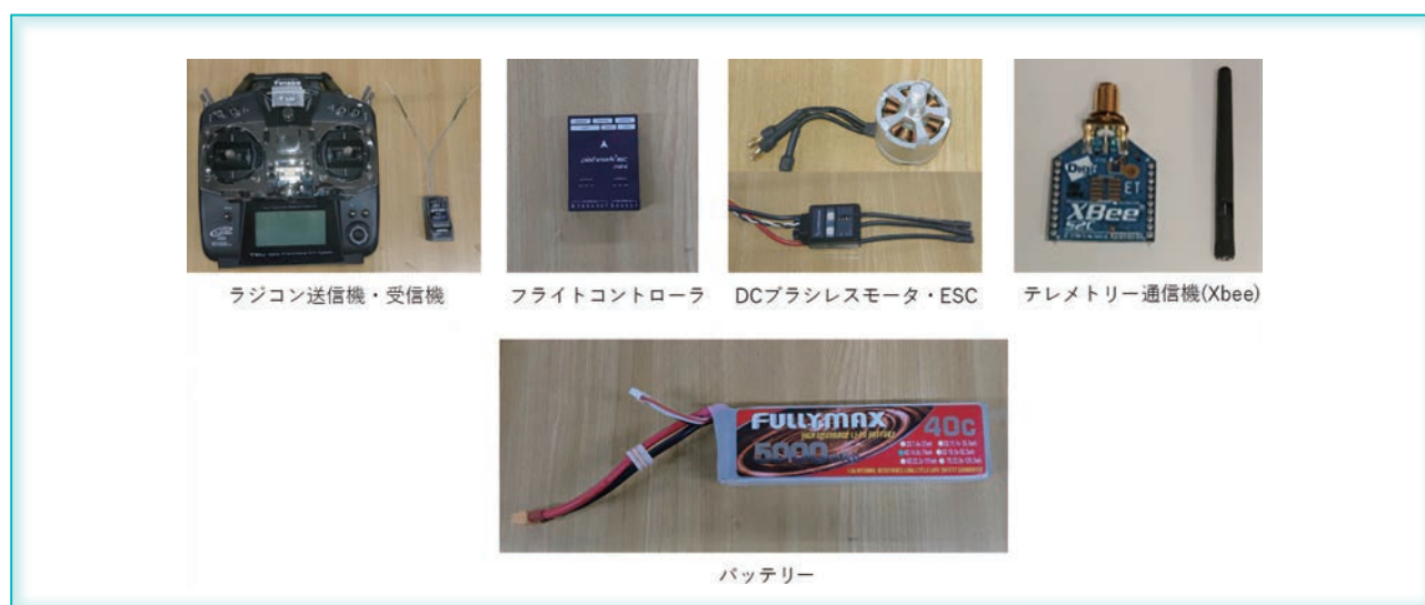
図7 ドローンの構成要素例
