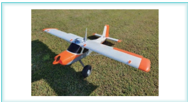
図3 飛行機型ドローン 機上に地上との通信機とRTK-GPSのアンテナを搭載している。
