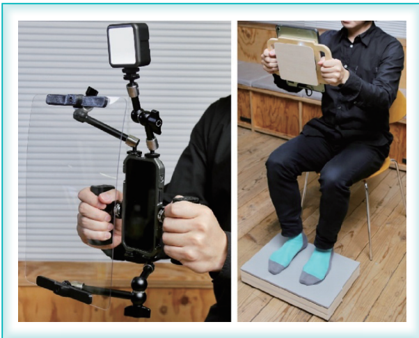
図7 モバイルハイタッチの配信機材（左） 手と足で感じる振動提示装置（右）
