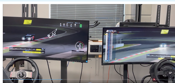
サーバ（左）の車両よりも競技端末（右）の車両が後方に位置している
