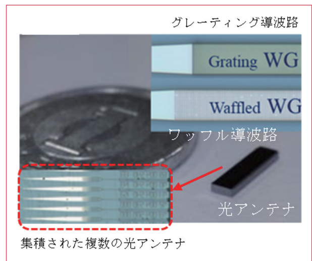
図6 光漏れ波アンテナ
