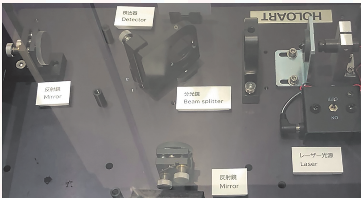
図5 マイケルソン干渉計。同じ振幅を持つ二つの光線が同じ場所から同時に出発し、西に向かう経路と南に向かう経路の終わりに反射鏡を置き、光線を干渉させると完全に振幅が2倍になる波と2倍にならない波が発生します。
