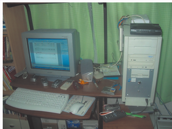
図5 SoftEther VPN の開発に使用していたマシン。なお、右上に載っているのが当時の自宅の光ファイバ回線の B フレッツの ONU と、図2とは別の固定 IPv4 アドレス8個の国産 PPPoE のルータ。
