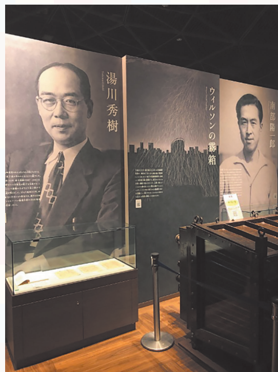
図2 写真右下の霧箱は、大阪市立大(現・大阪公立大)宇宙線研究所が、岡山県備前市三石にある旧船坂トンネル(JR山陽本線)内の地下宇宙線観測所に設置し、高い透過性を持つ宇宙線(ミュー粒子など)の観測に用いていたと考えられています。
