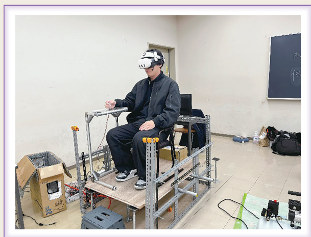
図10 改良した手作りモーションベース。前・後ろ両方の傾斜を提示できるようになった
