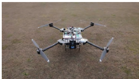
図1 4発型ロータマルチコプタ RTK-GPS, LTE 通信装置を搭載した運搬用大形機。
