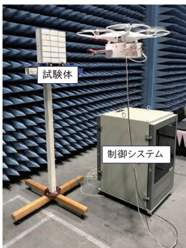
図 12 インフラ構造物の検査のためのドローン搭載ミリ波レーダシステム
