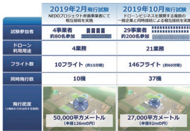
図 2 2019 年に実施された NEDO の運航管理システムの実証 (NEDO プレスリリースから) (3)
