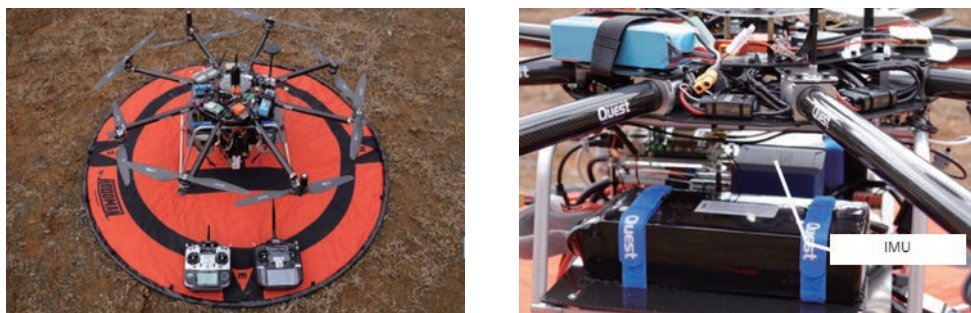
図 16 IMU を搭載した精密飛行ドローン「サルタヒコ」
