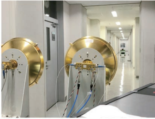
図 11 送受信機に光技術を用いた 300 GHz 帯無線通信実験の様子
