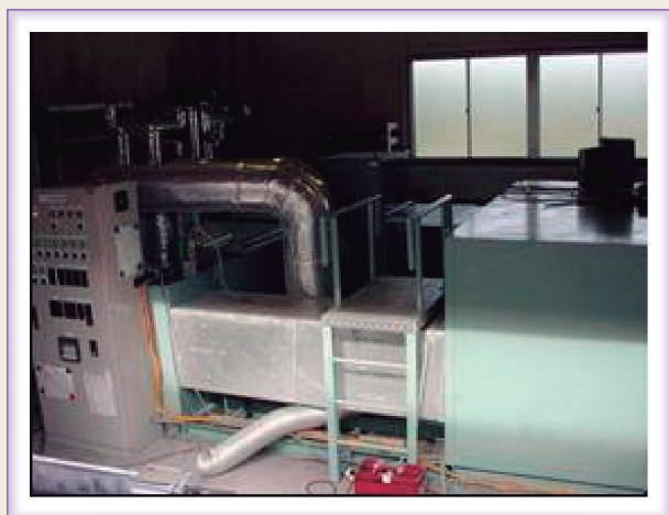
図8 試作機試験風洞 (加熱・冷却能力 5kW, 1999 年設置)
