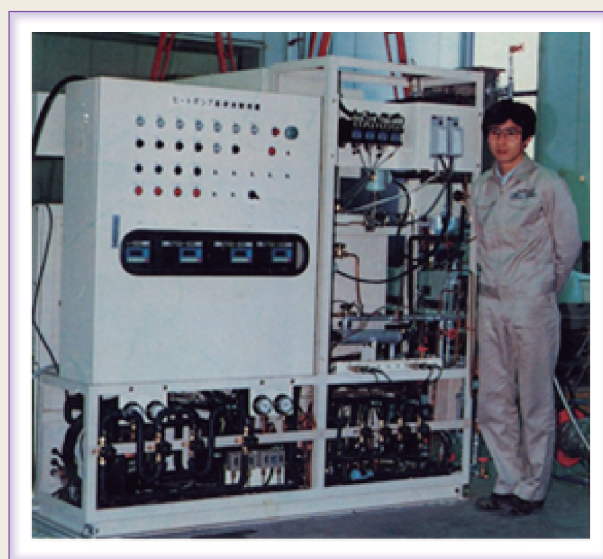
図4 2段圧縮式原理試作機 (加熱能力4 kW, 1987年設置)
