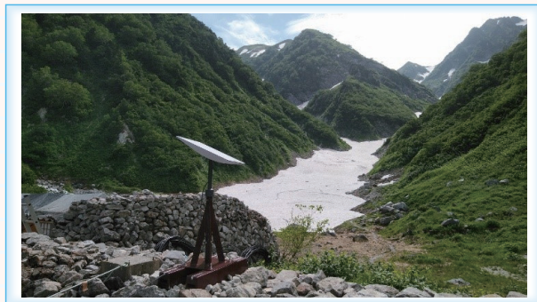
図 13 剣岳真砂沢ロッジに設置した Starlink アンテナ
