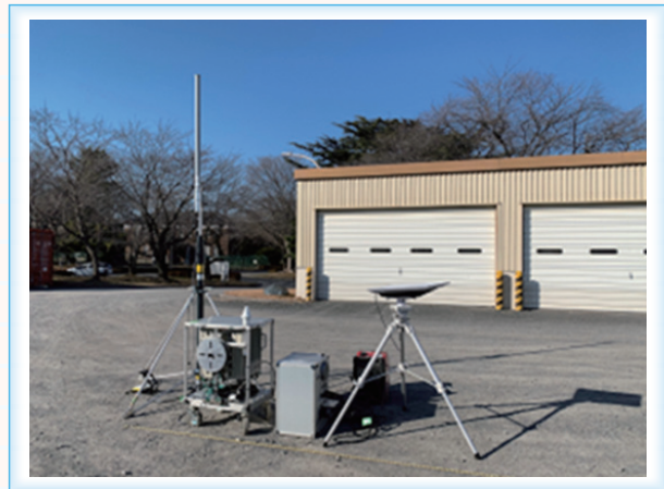
図 6 Starlink を搭載した可搬基地局
