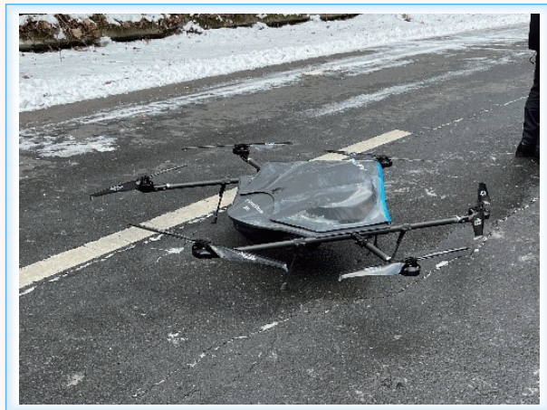
図 12 モバイル通信による遠隔制御ドローン機体
