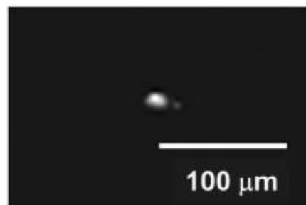
図 5. 出射光の近視野像の観察結果 ( \lambda=1.55\mu\text{m} ).
