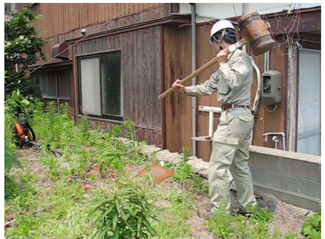
写真 2 宅地での表面波探査の一例。
