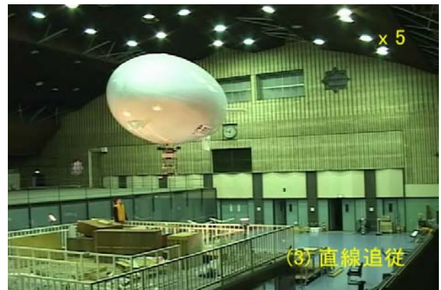
図 2：飛行船ロボットを使ったメッシュネットワークの通信実験
