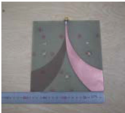
Fig. 1. Bipodal Vivaldi antenna of the GPR.
