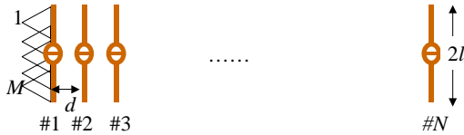
Fig. 1. Analysis model: a linear dipole array antenna.
