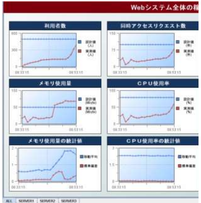
図4. 設計基準値と実測基準値の乖離による障害予兆検知例
