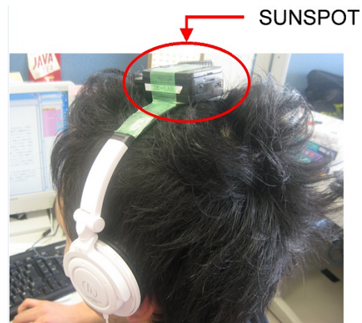
図 4: 加速度センサ付きヘッドホンを装着した状態
