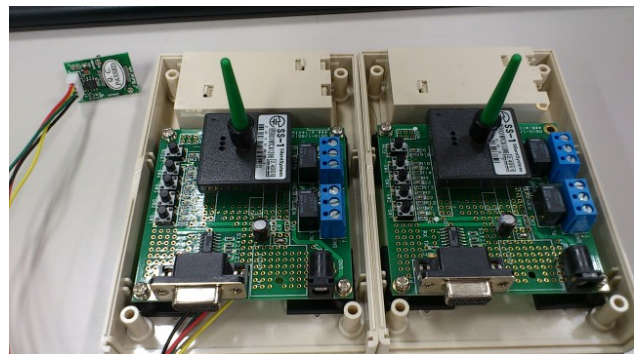
図 2: SS-1 センサーノード外観
