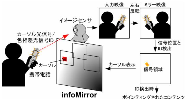
図4 光信号マーカーによるポインティング方式
