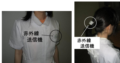
図 4: 送信機の装着図、胸(右)、頭(左)
