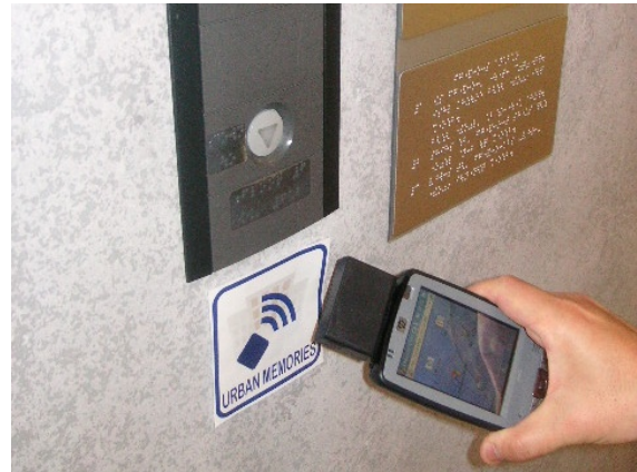
図 1: RFID タグを用いた情報交換
