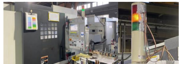
図 1 マシニングセンタとシグナルタワー (左: マシニングセンタ, 右: シグナルタワー)
