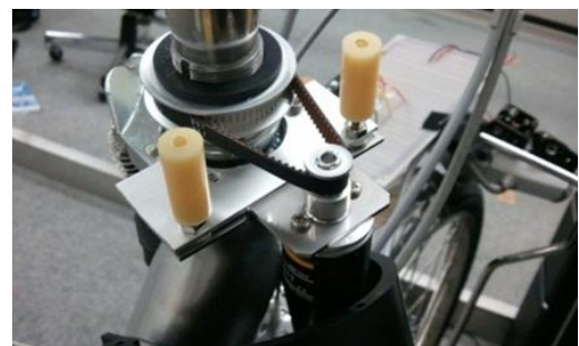
図4. ロータリーエンコーダを装着した自転車
