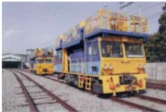
写真2 電力用保守用車 Photo2 Power electronics device maintenance car
