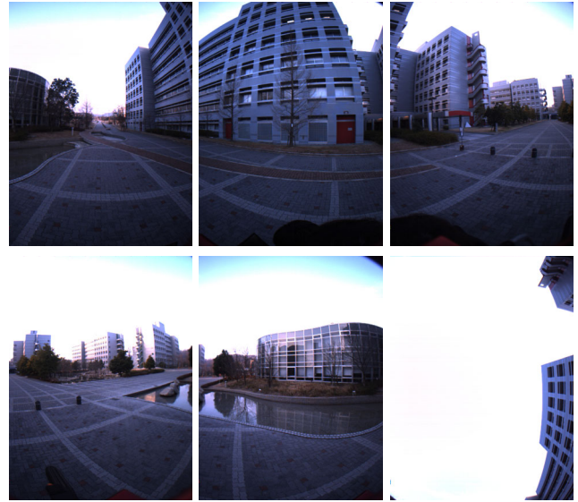
図 5: 全方位動画像の 1 フレームを構成する 6 枚の画像
