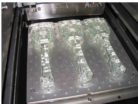
図 5. 光造形による筐体のプロトタイプング
