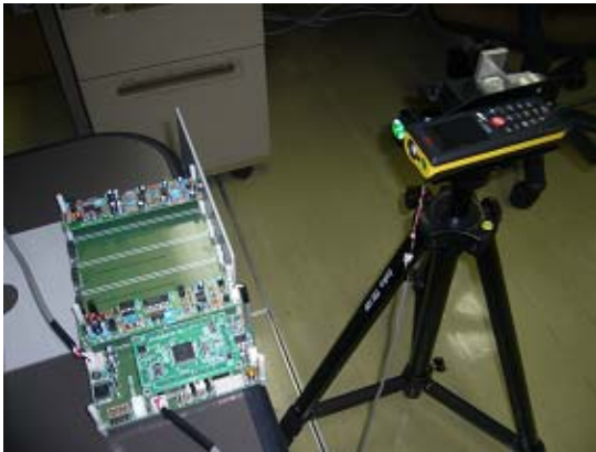
図4. 可視光通信のデータ通信実験
