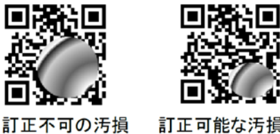
図 7 二次元コードの汚損
