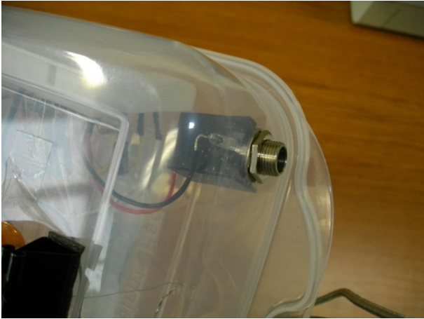
図4 モノラルジャックの取り付け図
