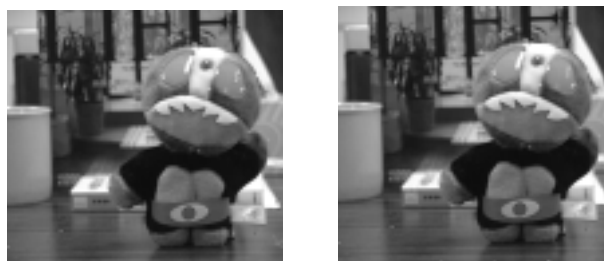
(a) 修復法#1による修復画像 SN比 = 36.84 [dB] (b) 修復法#2による修復画像 SN比 = 36.55 [dB]
