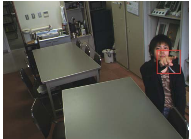
図 8: 1 フレーム前の指先座標の利用による復元領域の削減
