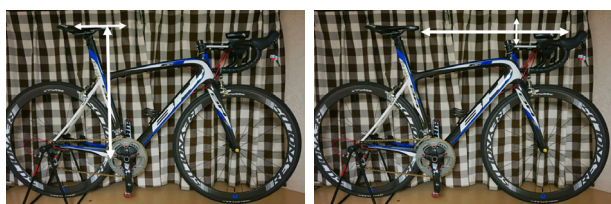
(a) サドルの位置 (b) ハンドルの位置 図 1: 自転車のポジション
