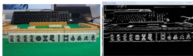
(a) 手牌の撮影画像 (b) エッジ抽出画像 図2 手牌画像の処理
