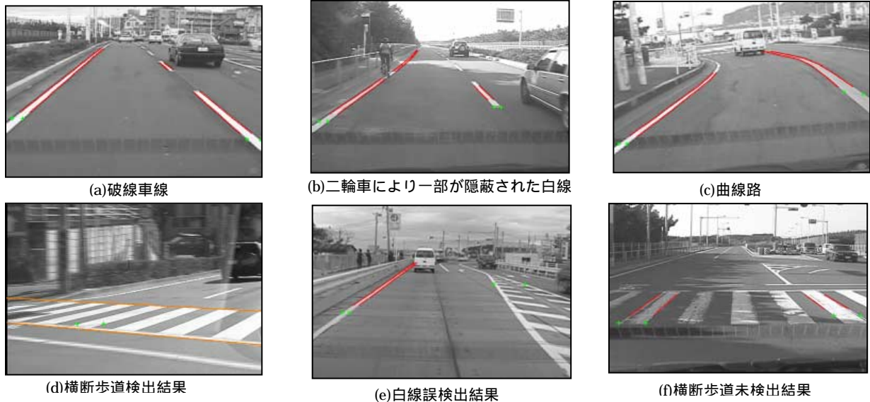
図 4：路面表示検出結果
