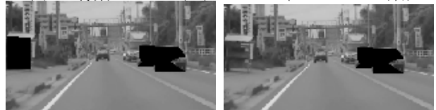
図4 車両候補領域(左)と車両領域(右)
