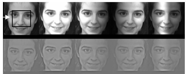
図 2 輝度情報に適当な係数をかけることでシェーディングを生じさせた画像、及び本提案法による処理画像例。上列左から、元画像、1.6倍輝度画像、左右それぞれから照明された画像、部分的に照明された画像。元画像上の四角の枠は(2)式中の m を求めている部分を示す。下列はそれぞれの本提案の処理画像。
