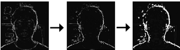
図5 人物輪郭線候補の抽出過程の例
