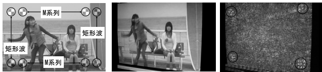
図7 基準信号の埋め込み位置(左, 信号を強調), 透かし強度±1で斜め再撮した映像(中央), 矩形波検出画像(右)
