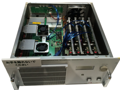
図 8. リアルタイム空間解像度・階調変換装置の内部
