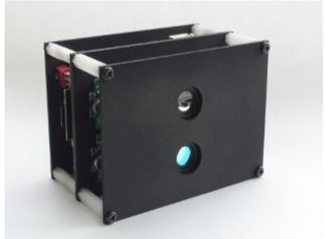
図 10 試作した 2 眼式マルチスペクトルカメラ
