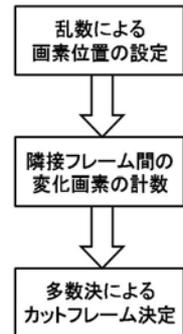
図4 カット検出の処理の概要
