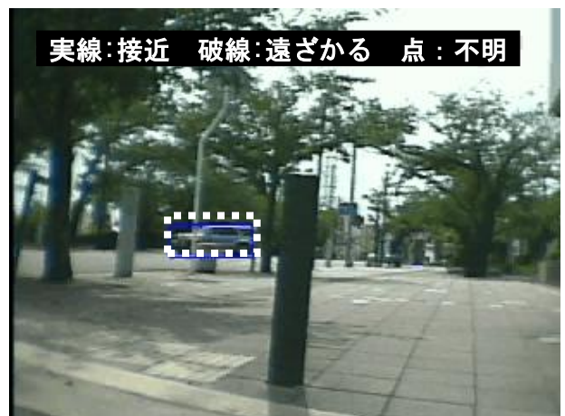
遮蔽物の存在する環境下で遠ざかる車両を認識し、非発報とした例
